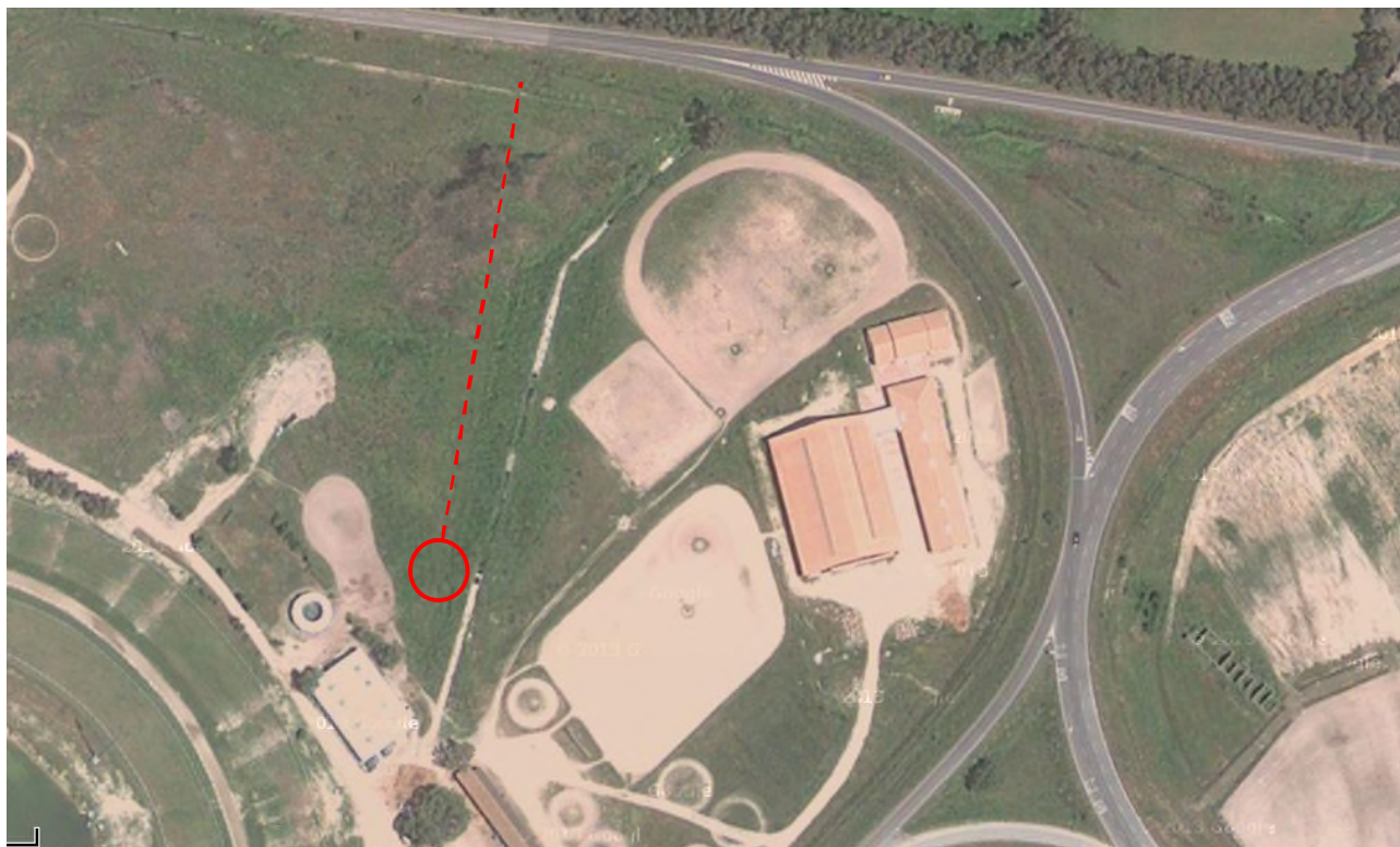
Figura 11: Individuazione dell'area di intervento (è indicata l'area interessata dal posizionamento dell'aerogeneratore e, tratteggiata, la direzione di sviluppo del cavidotto interrato fino alla cabina secondaria esistente)
