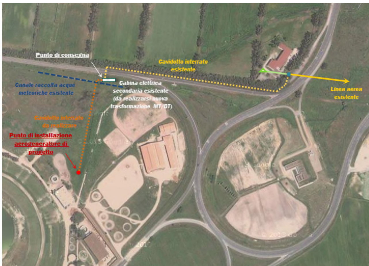
Figura 12: Indicazione di dettaglio posizione aerogeneratore e opere di connessione
